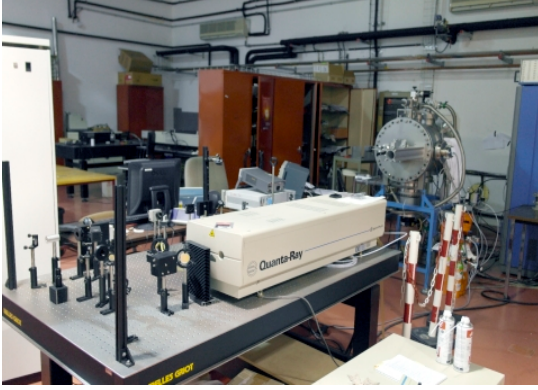
FIGURE 2.40 – Photographie du banc de photo-détachement avec en arrière plan le caisson d'expérience EPIC. Le moteur PEGASES est à l'arrière du caisson.
