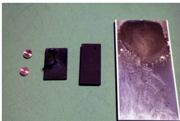
FIGURE 4.28 – Photographie de l'effet chimique sur la cavité et les écrans. De gauche à droite : Cu propre, écrans A et B attaqués chimiquement et une des parois de la cavité.
