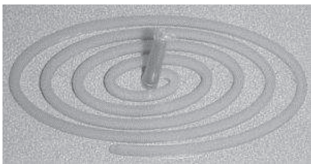
Figure 21 : produit du moulage avec un "spiral flow mould" [58]. La distance maximale parcourue par la matière injectée à une certaine pression donne des indications sur sa capacité à être moulée ou injectée.
