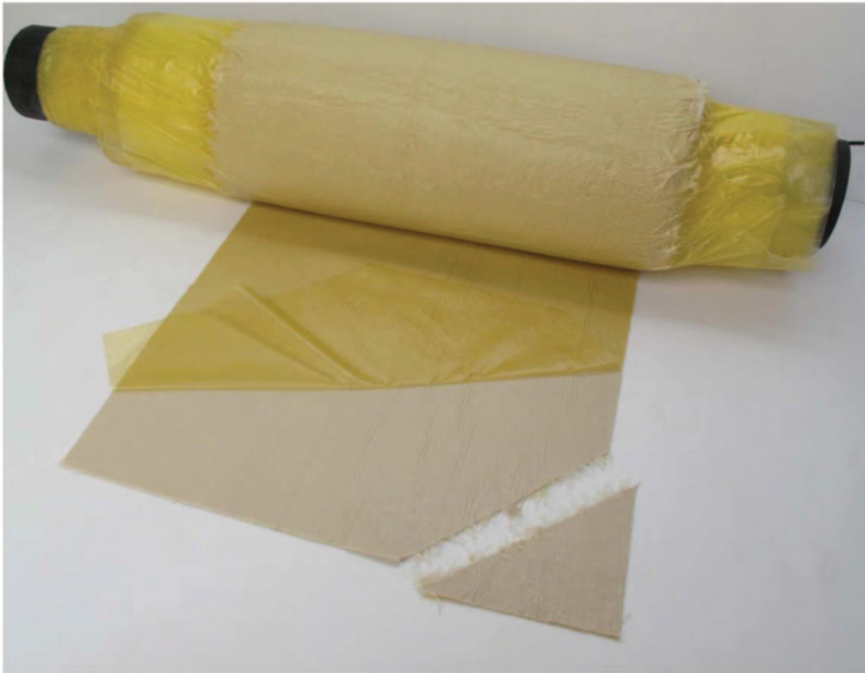
Figure 2 : rouleau de SMC après mûrissement. (thèse du Dr. Olivier Giraud, Grenoble 2006)
