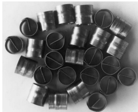
Figure 65 : Anneaux de Lessing utilisés par Velraj et al. [108].
