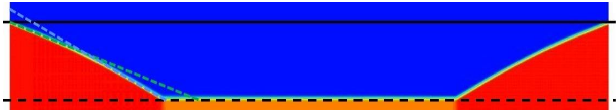
Figure 244 : [Num.] Vue zoomée de la Figure 243, f, avec les tangentes à l'interface solide, à 0 s (courbe verte) et à 240 s (courbe bleue).
