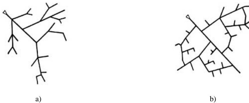
Figure 2 : Schéma général d'un réseau a) ramifié b) ramifié avec mailles [8].
