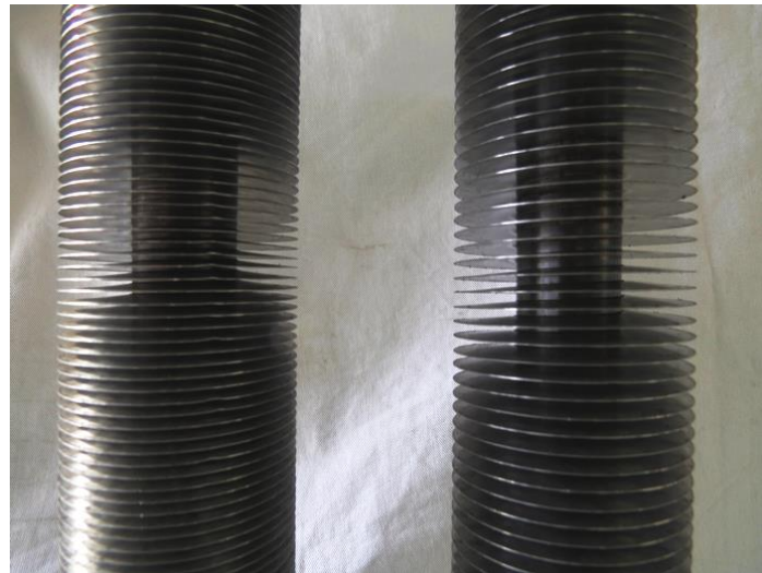
Figure 105 : Vue zoomée sur les différentes densités d'ailettes. 10 fpi à gauche, 7 fpi à droite
