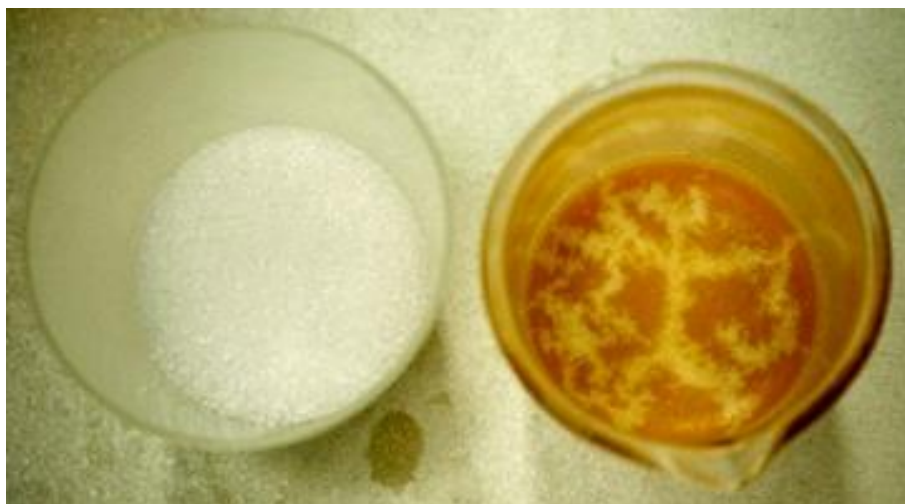
Figure 26 : Tris(hydroxyméthyl)-aminométhane avant (à gauche) et après (à droite) dix cycles à +/- 15 °C autour de sa température de transition de phase. ©Maxime Billoud
