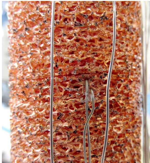
Figure 160 : Instrumentation de l'échangeur.
