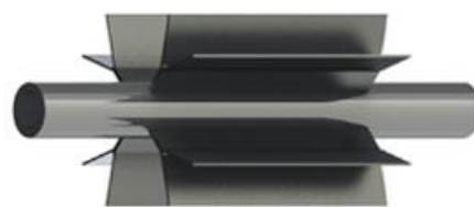
Figure 58 : Exemple de section d'un profilé en aluminium. Figure 59 : Vue d'artiste d'un tube à ailettes profilés [140].
