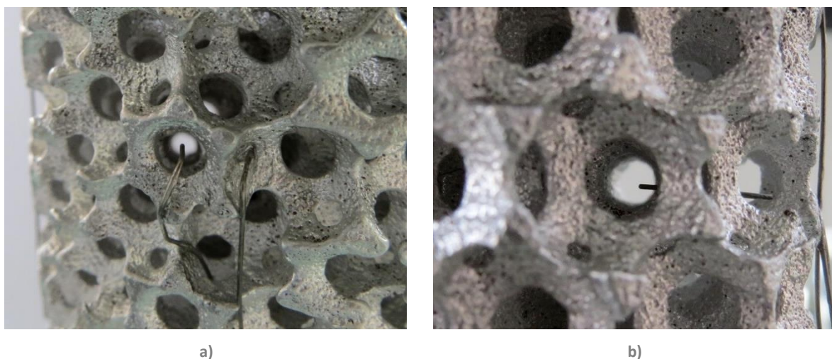
Figure 175 : Photographies de la section d'essais : a) Vue en plongée de l'instrumentation ; b) Vue traversante, rendue possible par la régularité de la structure.
