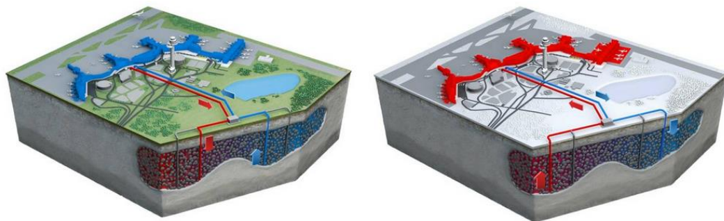
Figure 12 : ATES réversible, principe de fonctionnement été (à gauche) et hiver (à droite). © LfV
