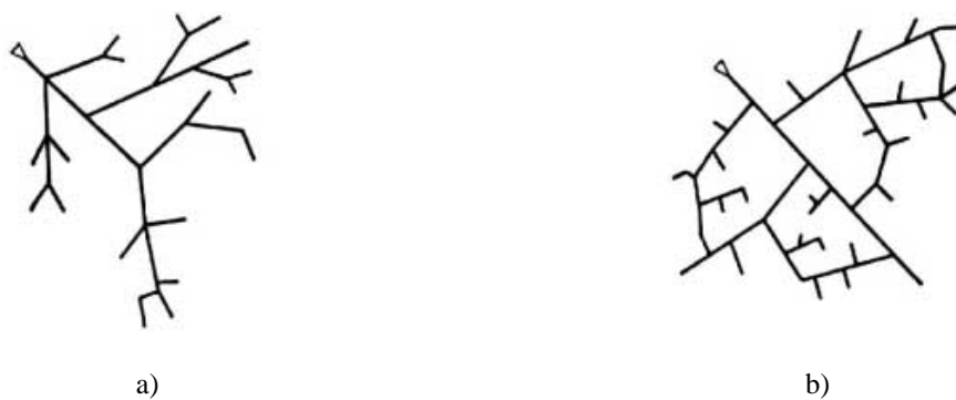
Figure 2 : Schéma général d'un réseau a) ramifié b) ramifié avec mailles [8].
