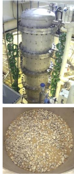
Figure 14 : Système de stockage d'énergie thermique sensible à contact direct huile/roche développé au CEA de Grenoble. Vue de l'extérieur (en haut) et vue du lit de roche intérieur (en bas). ©Arnaud Bruch.
