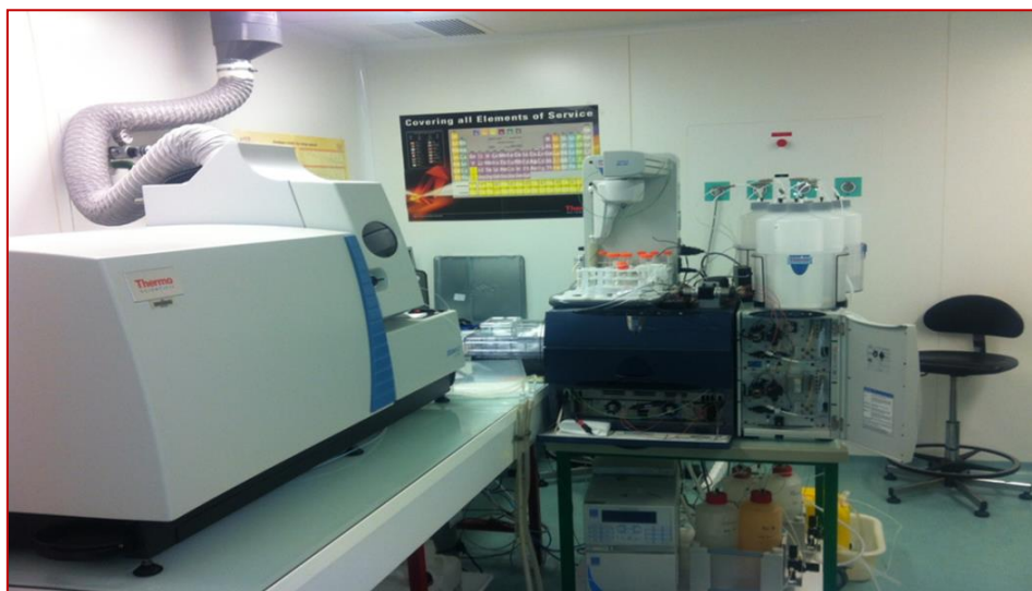
Figure IV-18 : Système de chromatographie liquide connecté à l'ICP-MS
