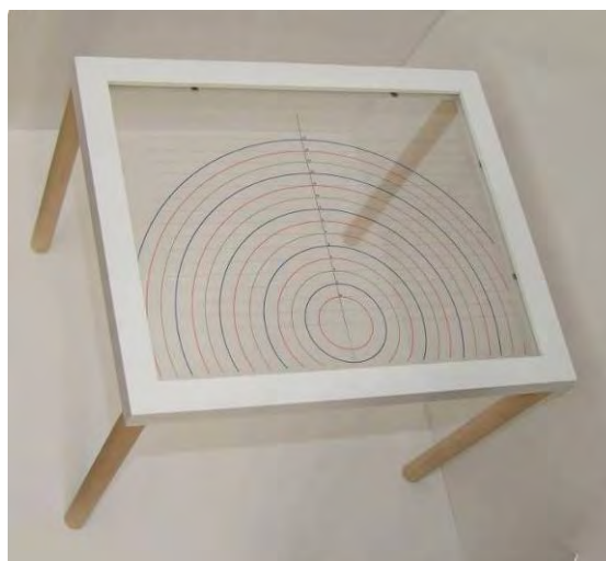
Figure 1 : Grille de mesure des diamètres des ouvertures des tessons de bord. (Modèle conçu et réalisé par F. Kherbouche, 27 x 33 x 25 cm)
