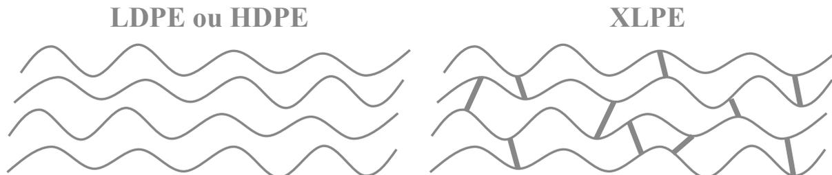
Figure 6 : Différences de réticulation inter-chaîne entre les polyéthylènes linéaires (LDPE et HDPE) et réticulé (XLPE).
