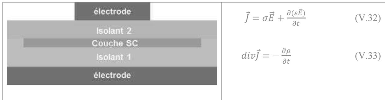
Figure 89 : Schéma du modèle des éléments finis de la structure MIM avec une couche semi-conductrice homogène et équations utilisées correspondant à l'expression du courant total et à la loi de conservation de la charge.
