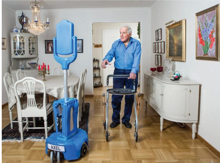
FIGURE 1.5 – Le robot Giraffplus permettant une interaction audio et visuelle avec des personnes distantes
