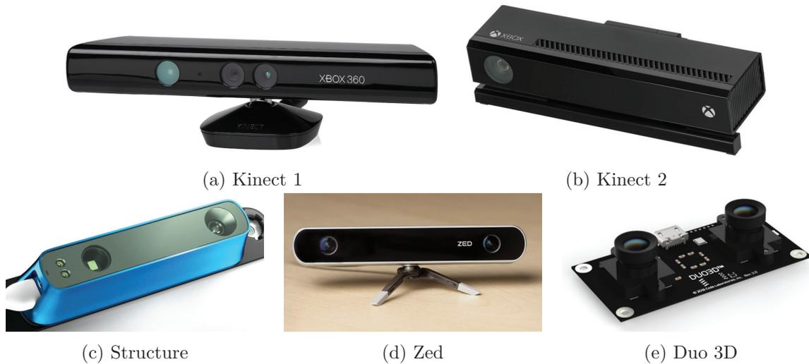
FIGURE 2.6 – Différents modèles de caméras de profondeur
