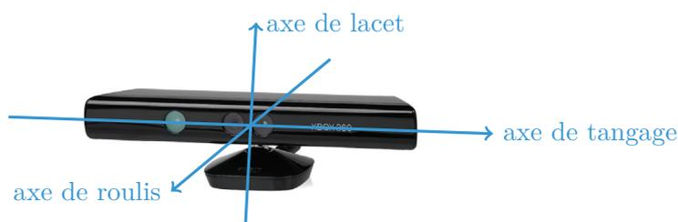
FIGURE 3.10 – Axes de roulis, de tangage et de lacet de la caméra
