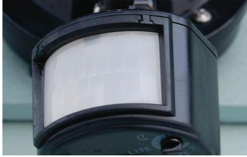
FIGURE 2.5 – Capteur infrarouge passif
