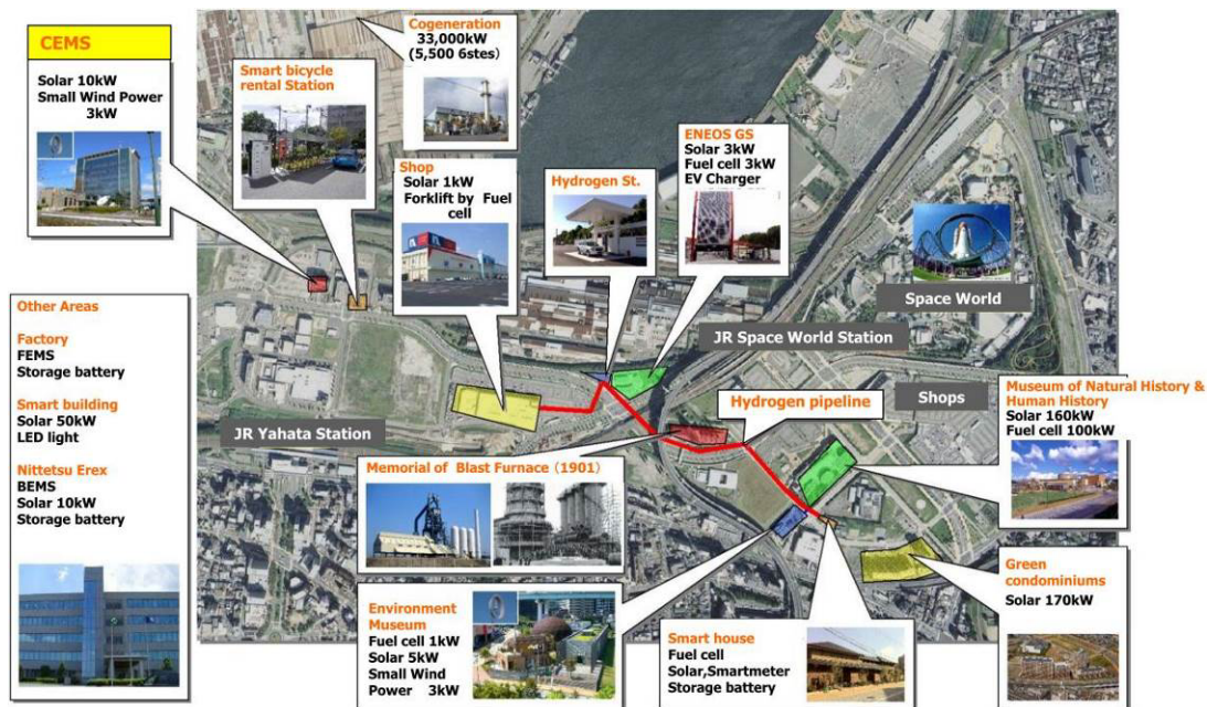
Figure 5.8 : Pipeline hydrogène et expérimentations reliées à Higashida
