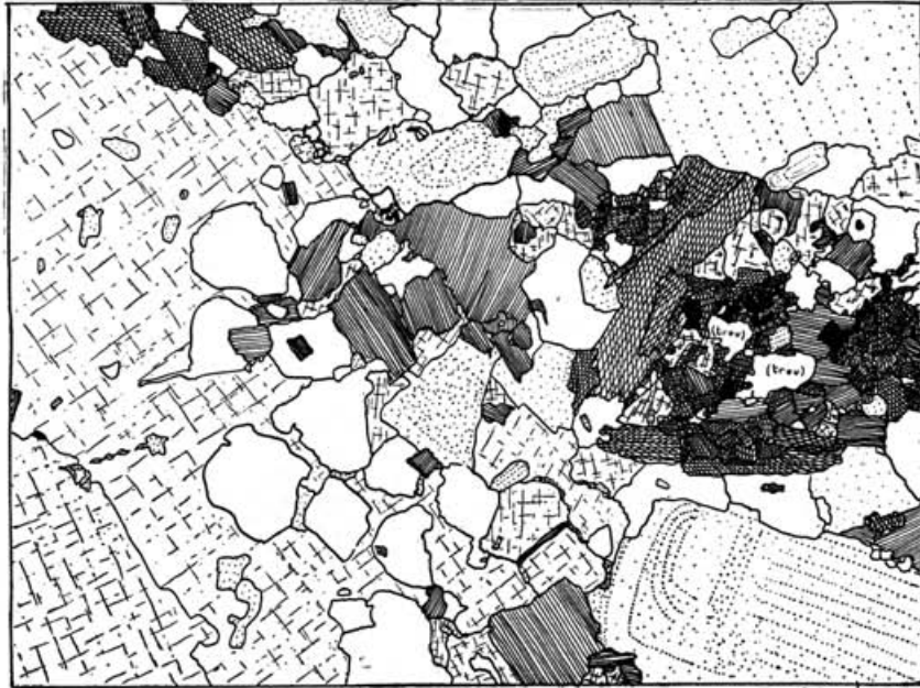
FIG. 12. — Structure en plaque mince de granite à amphibole. St-Laurent de Chamouset ( \times 16 ). Quartz : blanc ; Biotite : hachures parallèles ; Microcline : traits fins perpendiculaires ; Hornblende : hachures croisées ; Plagioclase : points ; Magnétite : noir.
