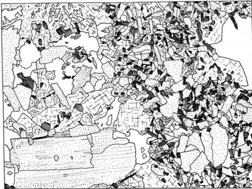
FIG. 13. — Structure en plaque mince de granite à amphibole avec enclave à grain fin ( \times 16 ). Les minéraux sont représentés suivant les mêmes conventions que pour la figure 12.
