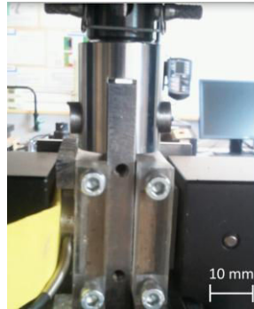
Figure III - 9 : Dispositif expérimental de mesure du frottement argile / acier
