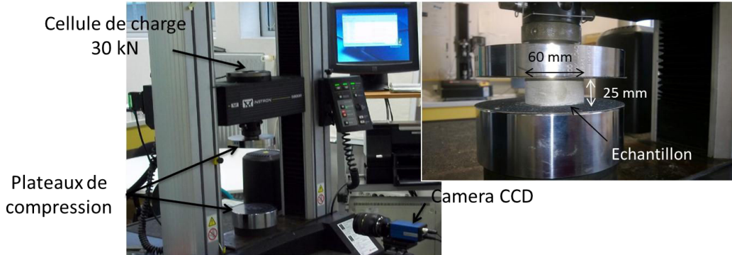
Figure II - 3 : Dispositif expérimental de compression libre
