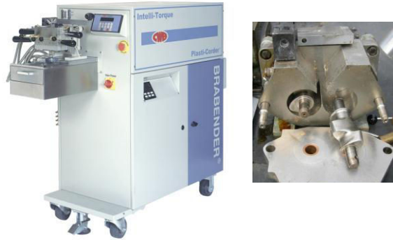
Figure I - 12 : Rhéomètre de couple (Brabender CWB, 2014)
