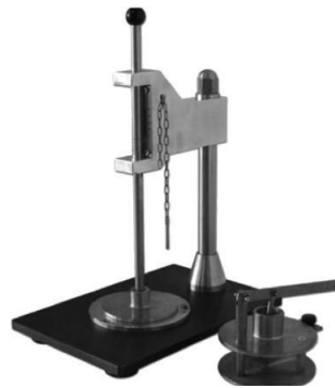
Figure I - 10 : Système d'essai de Pfefferkorn (Sassuolo Lab, 2012)
