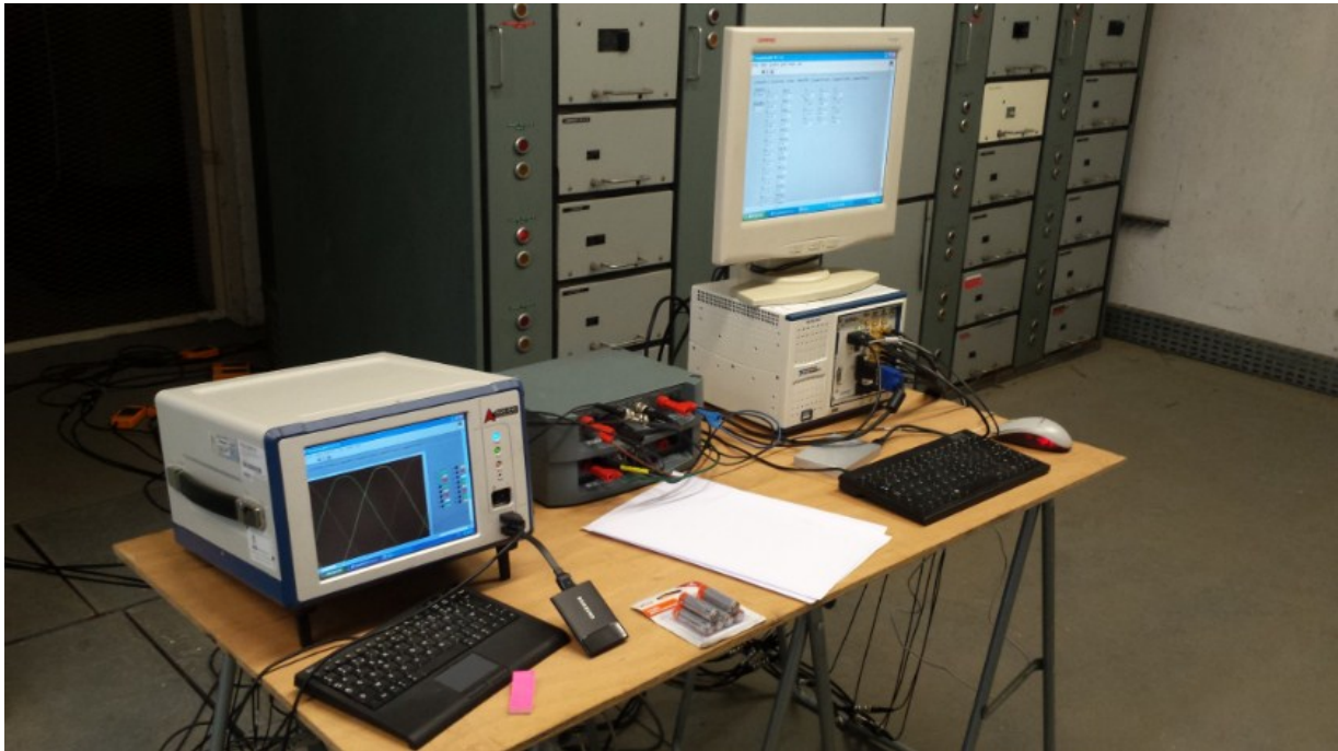
Figure 6-4 : les deux ordinateurs d'acquisition de mesures et les conditionneurs de tension (au milieu)
