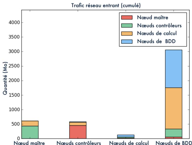
FIGURE 6.15 : Quantité de données échangées en fonction du type de nœuds dans une configuration avec un cluster REDIS de 4 nœuds avec réplication de données.
