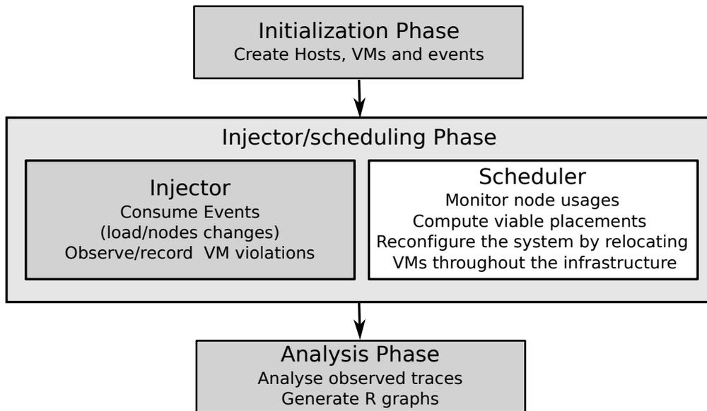
FIGURE 8.1 : Illustration du fonctionnement de VMPlaceS.
