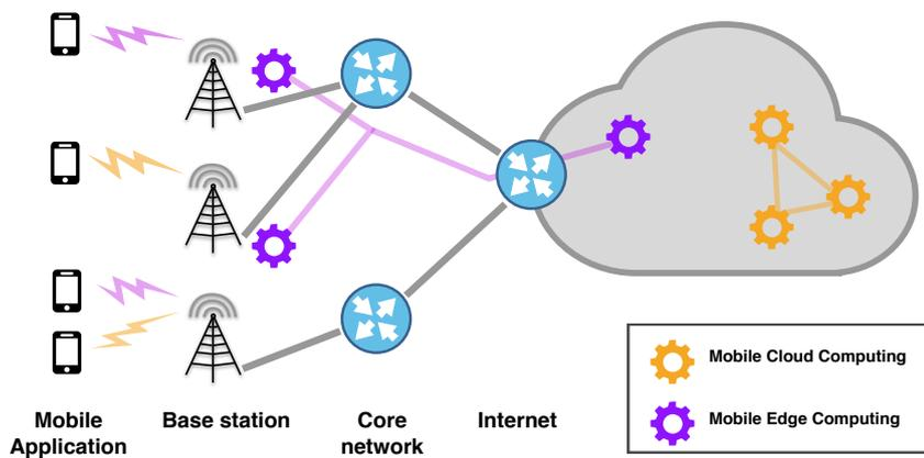
FIGURE 3.6 : Illustration du modèle de Edge Computing.
