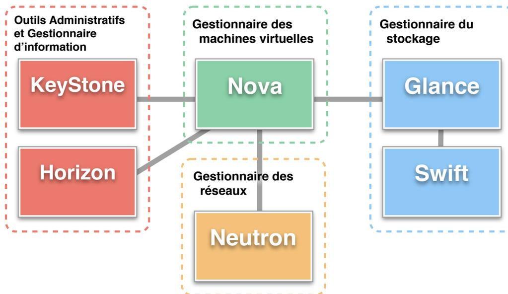
FIGURE 2.2 : Architecture du système OpenStack.
