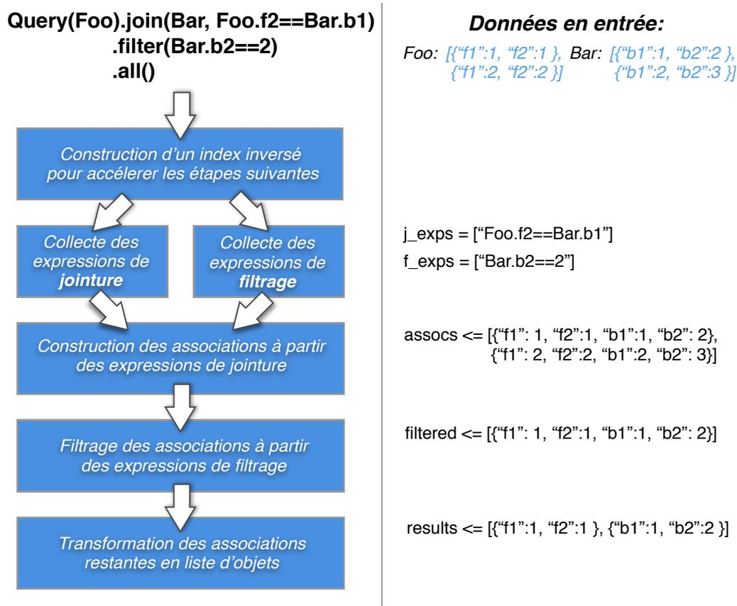
FIGURE 6.5 : Étapes du processus de jointure dans *Rome*.
