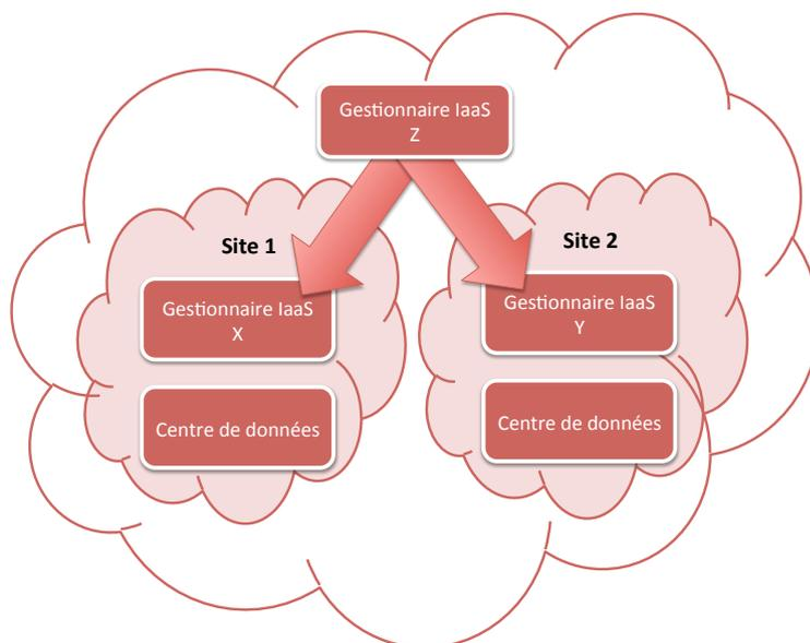
FIGURE 3.5 : Schématisation d'une fédération reposant sur une architecture *Multitier* ([25]).
