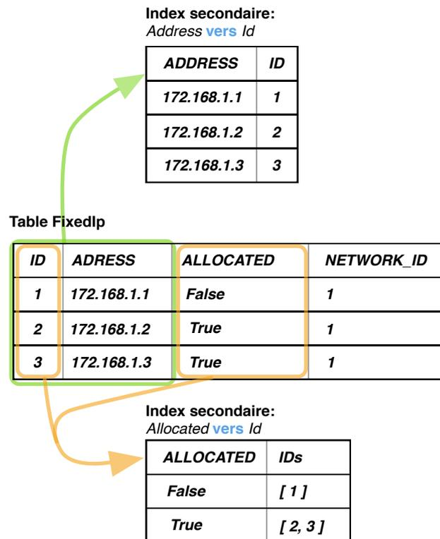
FIGURE 6.8 : Illustration du fonctionnement des index secondaires.
