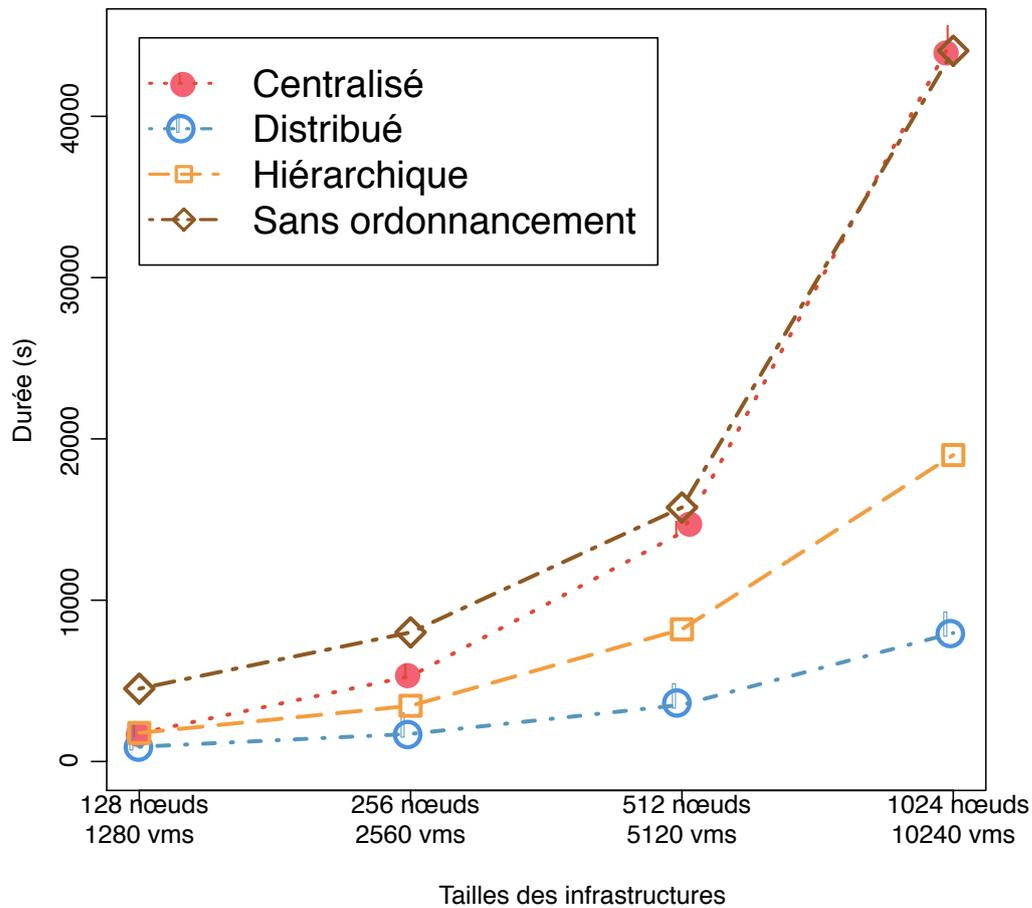
FIGURE 8.4 : Cumul des temps de surcharge des hôtes physiques, en fonction des algorithmes.
