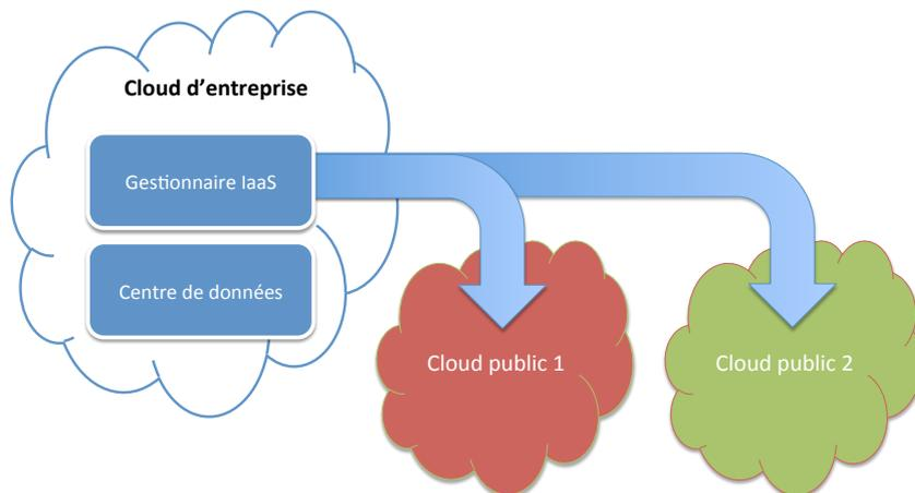
FIGURE 3.2 : Schématisation d'une fédération reposant sur une architecture de type *Bursting* ([25]).
