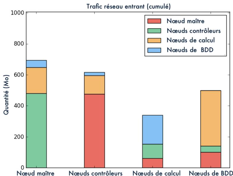
FIGURE 6.13 : Quantité de données échangées en fonction du type de nœuds dans une configuration avec un unique nœud MySQL.
