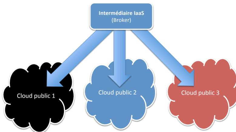
FIGURE 3.3 : Schématisation d'une fédération reposant sur une architecture de type *Broker* ([25]).
