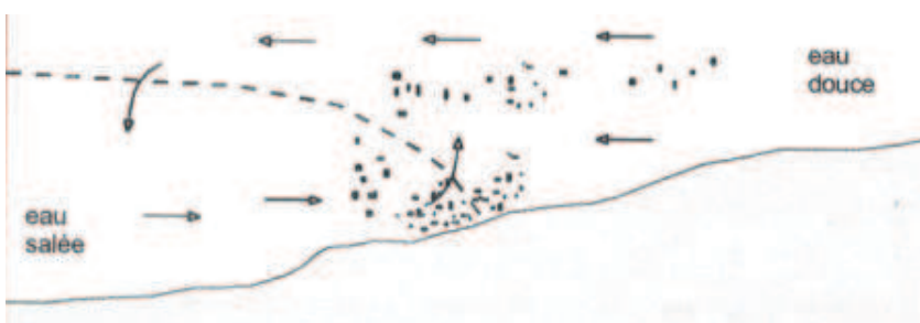
Figure 9 : Circulation résiduelle et transport de particules fines de sédiment (d'après Dyer, 1986 modifié par Sottolichio 1999).
