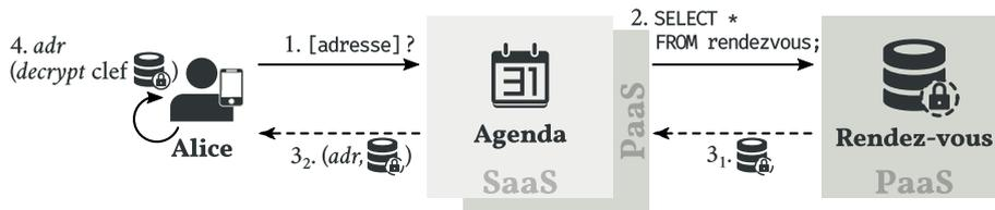
FIGURE 10 – L'opération [adresse] sur l'agenda personnel protégé par la technique du chiffrement symétrique.
