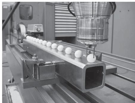
Figure 1.30 – Exemple d'utilisation d'une barre à boules multiples, d'après [Trapet *et al.*, 2006].
