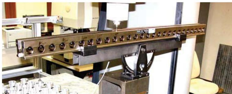
Figure 1.27 – Cale à gradins de type Koba d'après [Hennebelle, 2007].
