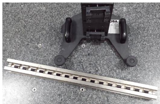
Figure 2.14 – Koba-Step du LNE utilisée pour identification de l'erreur de positionnement linéaire apparente de l'axe de la MMT.
