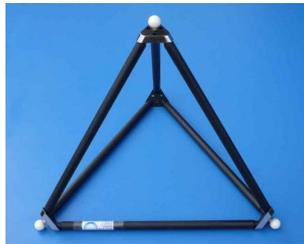
Figure 1.33 – Étalon en treillis d'après [Trapet, 2015].
