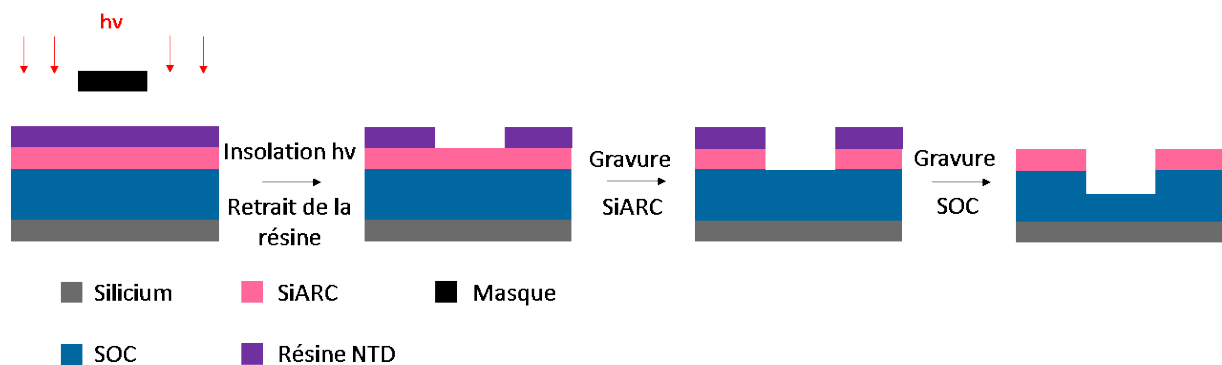
Figure V-2 Procédé de photo-lithographie pour d'obtention de motifs dans un substrat de SOC, utilisé pour le masque OCHA2
