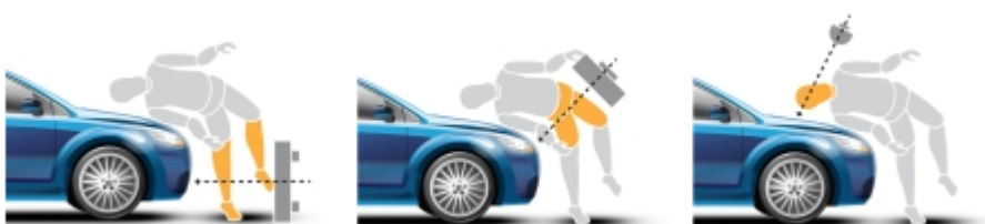
FIGURE 0.3.1 – Cas de chocs issu de la norme de protection des piétons (Bas des jambes, Cuisse, Tête) .
