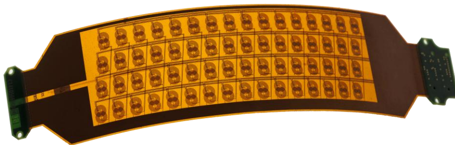
Figure 1.15 : Capteur multiéléments composé de bobines gravées sur film Kapton [Decitre_2014]
