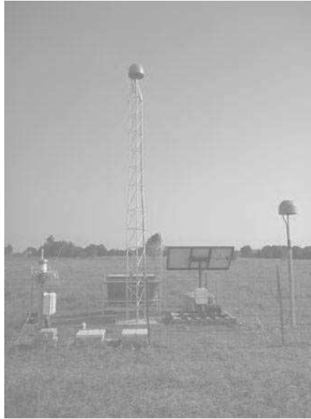
FIGURE 3.17 – Station SMAPSITEA2 dédiée à la mesure de l’humidité par analyse du SNR du réseau PBO H_2O (USA) développé par K. Larson.
