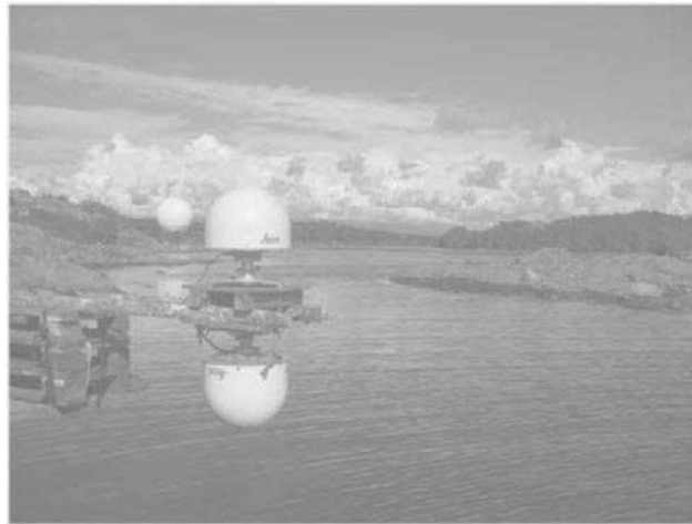
FIGURE 3.18 – Marégraphe GNSS-R de l’observatoire spatial de Onsala. (modifié d’après Löfgren (2014))
