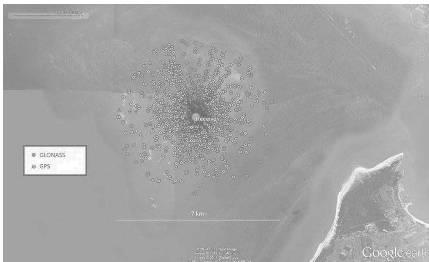
Positions des points de réflexions spéculaires des ondes GPS (orange) et Glonass (vert) obtenues durant une semaine de simulation ; positions des satellites actualisées toutes les quinze minutes.
