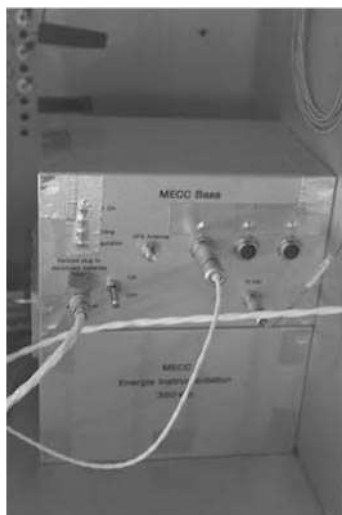
FIGURE 5.2 – Le module MECC contenant la centrale inertielle "ICDV".
