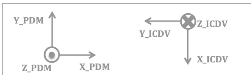
FIGURE 5.6 – Axes de l'ICDV orientés par rapport aux axes du PDM.
