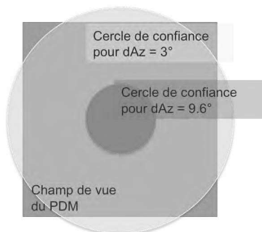
FIGURE 5.38 – Représentation des deux cercles de confiance à l'échelle du champ de vue du PDM au sol
