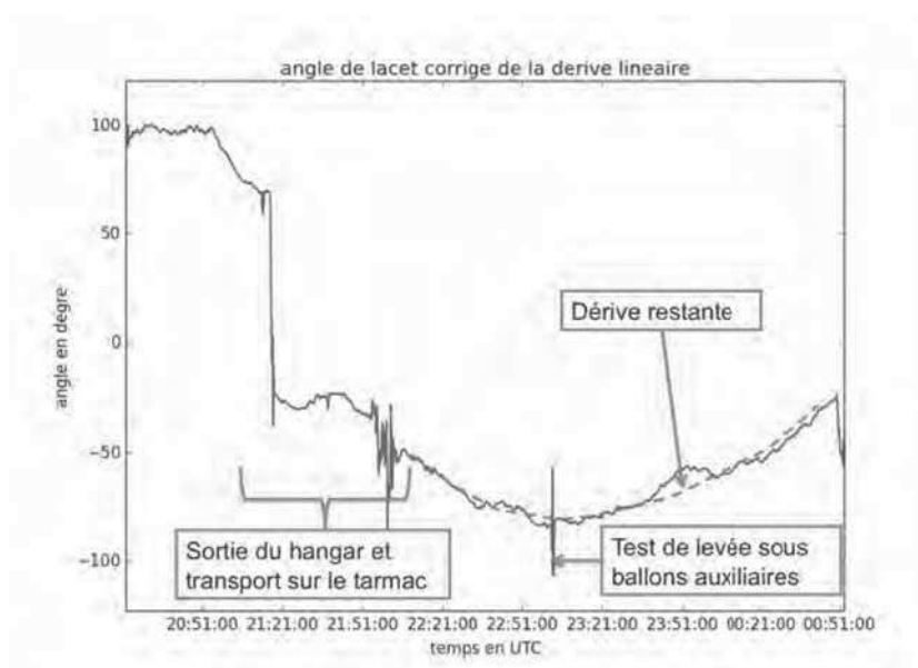
FIGURE 5.10 – Angle de lacet corrigé de la dérive linéaire lorsque la nacelle se trouve encore au sol.
