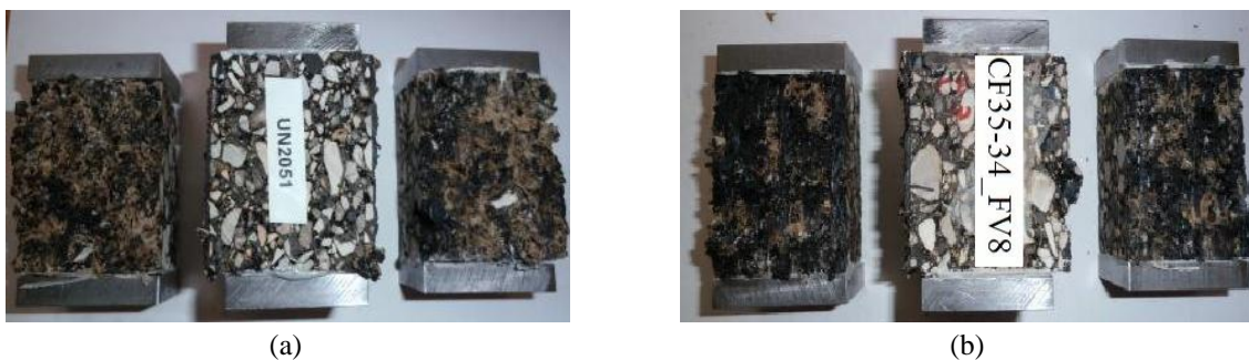
Figure II. 48 : Mode de rupture de l'interface: (a) interface UN ; (b) 2x3 maille FV8
