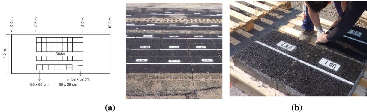
Figure II. 3 : (a) Plan de disposition des plaques sur chaque sous-section; (b) Détail sur les plaques préparées de la sous-section UN, c) Plaques en bicouche ( $52 \times 52 \times 10 \text{ cm}^3$ )
