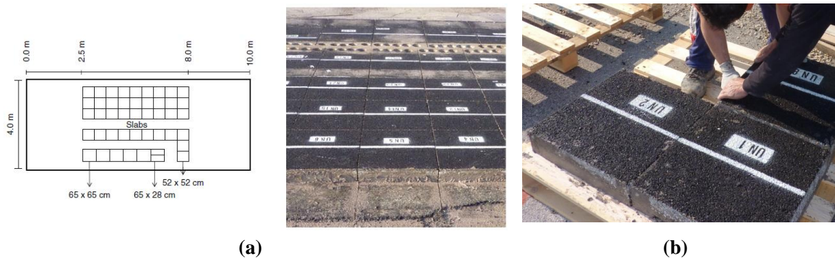
Figure II. 3 : (a) Plan de disposition des plaques sur chaque sous-section; (b) Détail sur les plaques préparées de la sous-section UN, c) Plaques en bicouche ( 52 \times 52 \times 10 \text{ cm}^3 )
