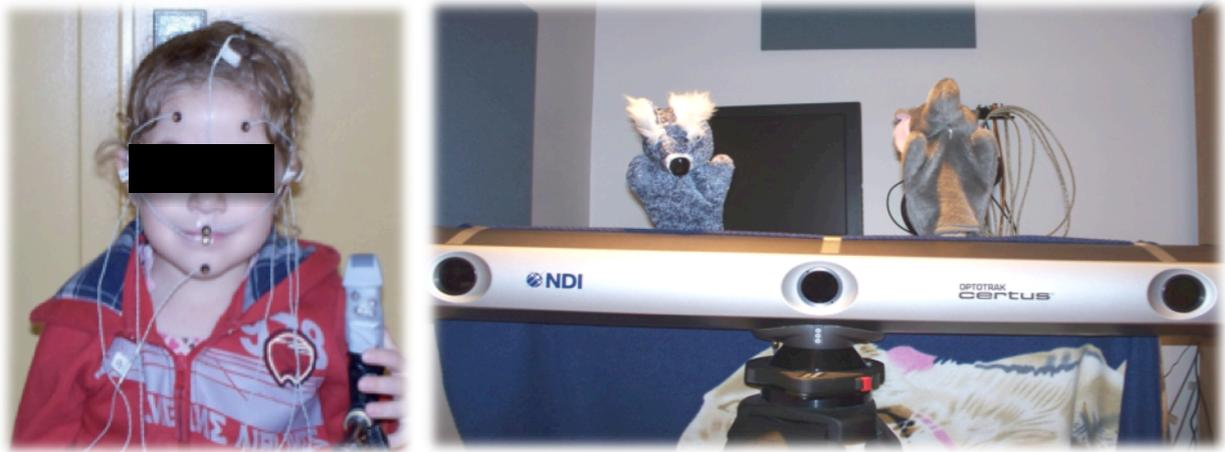
Figure 2.3. (a) Disposition des diodes infrarouges sur le visage d'un participant et sur la sonde. (b) Le bloc caméra de l'Optotrak utilisé comme théâtre de marionnettes.
