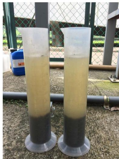
**Figure 17 : Décantation des boues A après échantillonnage sur le pilote A/B**
