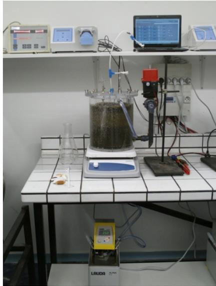
**Figure 16: Installation complète d'un réacteur avec pompe péristaltique, bain thermostaté et agitateur.**
