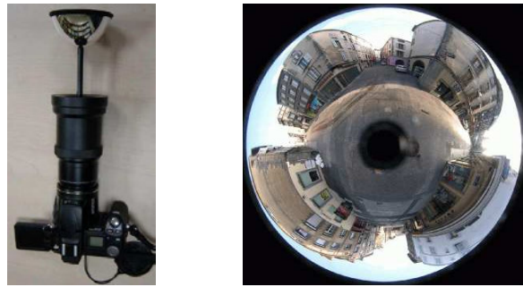
(a) Capteur catadioptrique. (b) Vue de rue avec ce capteur.
