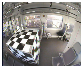
FIGURE 2.7 – Cube utilisé pour le calibrage des caméras dans le projet BOSS [Bos, 2009].
