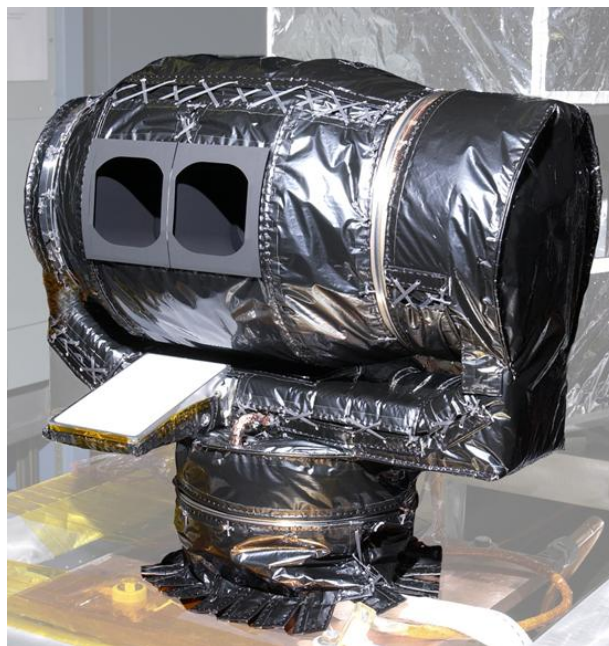
FIG. 4.1: Vue de l'instrument Mars Climate Sounder. On y distingue deux orifices qui sont l'entrée des télescopes, deux axes de rotation (en azimuth et élévation), et la plaquette blanche le miroir pour la calibration par le soleil.
