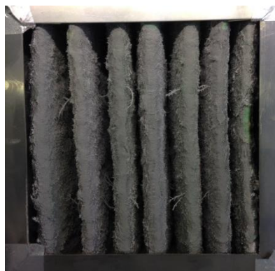
Figure 4-35 - Photographie du filtre combiné colmaté en fin d'étude
