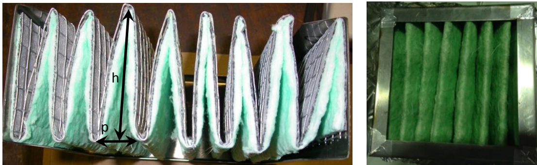
Figure 4-10 – Prototype de filtre F7-combiné en géométrie plissée
