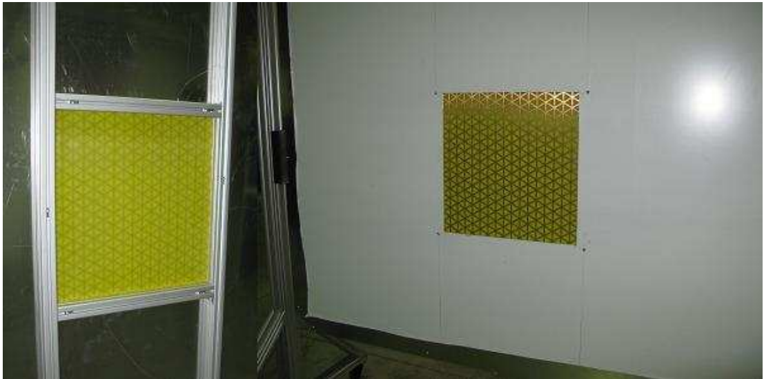
Figure 60 : A gauche : photographie du banc coté réception une fois un échantillon positionné. A droite : photographie du banc coté émission une fois un échantillon positionné en buté contre la tôle d'aluminium.
