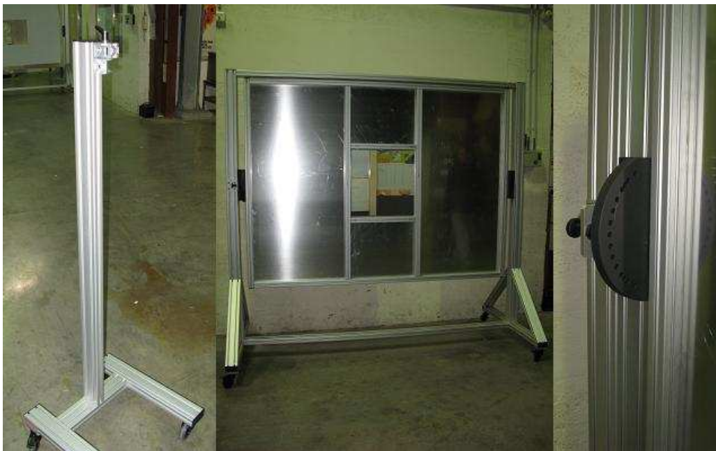
Figure 59 : A gauche : photographie d'un des deux pieds d'antenne fabriqué par Elcom. Un système de pivot permet de passer très simplement d'une polarisation horizontale à verticale (équivalente à TE/TM). Au milieu : photographie du banc (coté réception). 4 poutrelles de maintien assurent la robustesse du dispositif et les deux en position horizontale peuvent se déplacer suivant l'axe vertical pour assurer le maintien des échantillons. A droite : photographie du système de goupille auto bloquante pour le repérage des angles.
