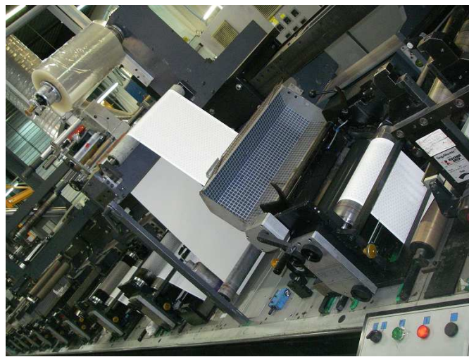
Figure 91 : Vue d'ensemble de la machine d'impression flexographique utilisée.
