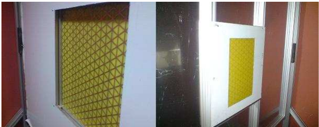
Figure 61 : A gauche : photographie du banc coté émission avec un échantillon mis en place ainsi qu'un adaptateur A3. L'échantillon est en butée contre l'adaptateur et plus contre la tôle métallique. A droite : Photographie du banc côté réception avec un échantillon mis en place ainsi qu'un adaptateur A3.
