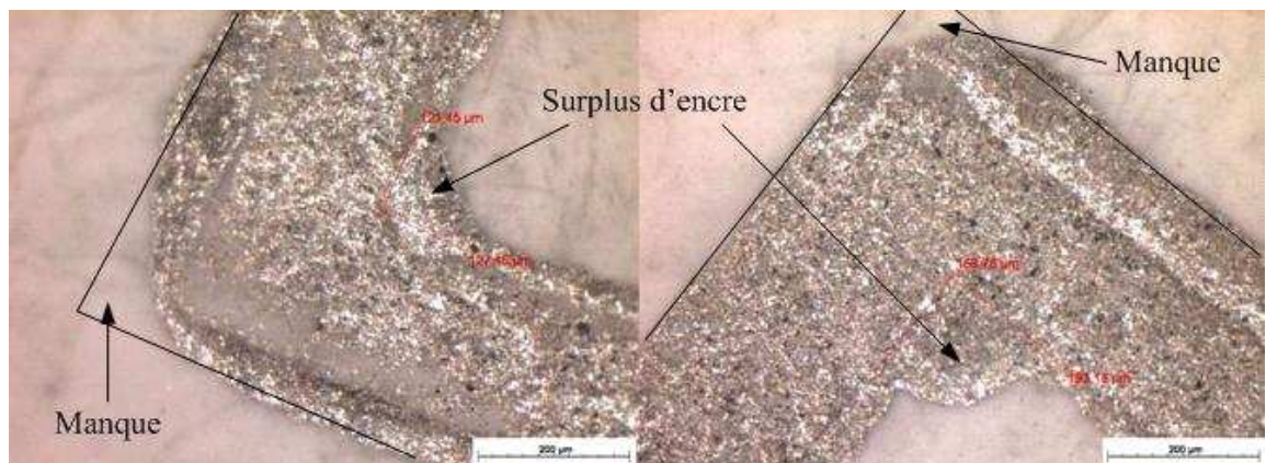
Figure 115 : Photographie d'un angle droit imprimé avec un anilox de 13\text{cm}^3/\text{m}^2 à gauche et avec un anilox de 16\text{cm}^3/\text{m}^2 à droite.
