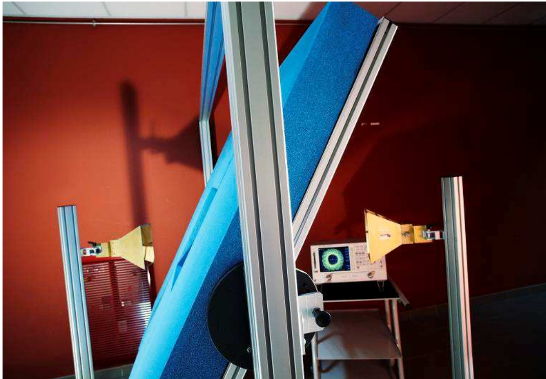
Figure 63 : Photographie de l'ensemble des éléments du banc de mesure (excepté les câbles) une fois l'absorbant mis en place. Le panneau du banc est incliné à 20^\circ .
