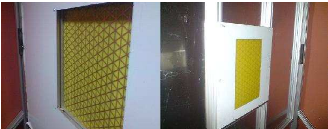
Figure 61 : A gauche : photographie du banc coté émission avec un échantillon mis en place ainsi qu'un adaptateur A3. L'échantillon est en butée contre l'adaptateur et plus contre la tôle métallique. A droite : Photographie du banc côté réception avec un échantillon mis en place ainsi qu'un adaptateur A3.
