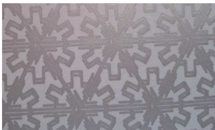
Figure 95 : Photographie d'une impression en deux passes où un décalage existe.
