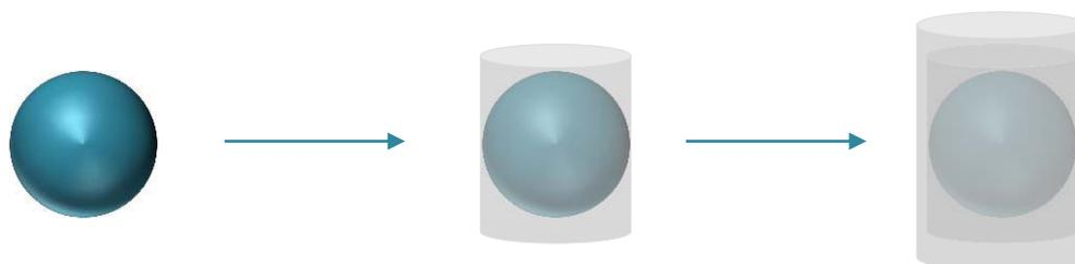
Figure 51 : Illustration du processus de croissance de la coquille NaYF<sub>4</sub>
