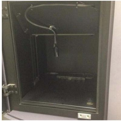
Figure 96 : Photo de l'installation de la diode laser dans l'enceinte de l'IVIS Spectrum®
