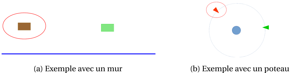
FIGURE III.8 – Exemple de situations de détection possible même si l'estimation est mauvaise. Sur l'image III.8a un véhicule, dont la vraie position est représentée par un rectangle vert, a sa position estimée représentée par le rectangle marron avec l'ellipse d'incertitude rouge. Pourtant si le mur bleu est cherché, il est possible de le trouver, y compris dans la position erronée. L'idée est similaire pour l'image III.8b, un poteau (représenté en bleu) est cherché à une distance donnée par rapport à un véhicule orienté (représenté par un triangle). Le poteau pourra être détecté à partir de la "vraie" position (en vert) mais également à partir de la position estimée (en rouge).
