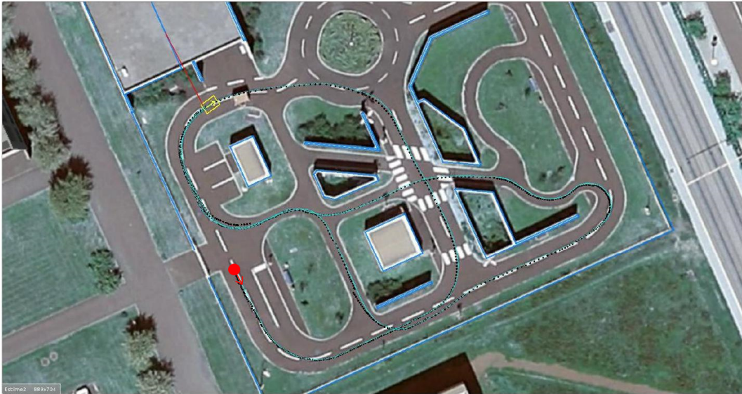
FIGURE IV.35 – Résultats pour la localisation avec quatre télémètres laser. La trajectoire estimée est représentée en noir. La trajectoire de référence (donnée par le GPS-RTK) apparaît en cyan. Le point de départ est dessiné en rouge. Le point d'arrivée est représenté par le rectangle jaune.
