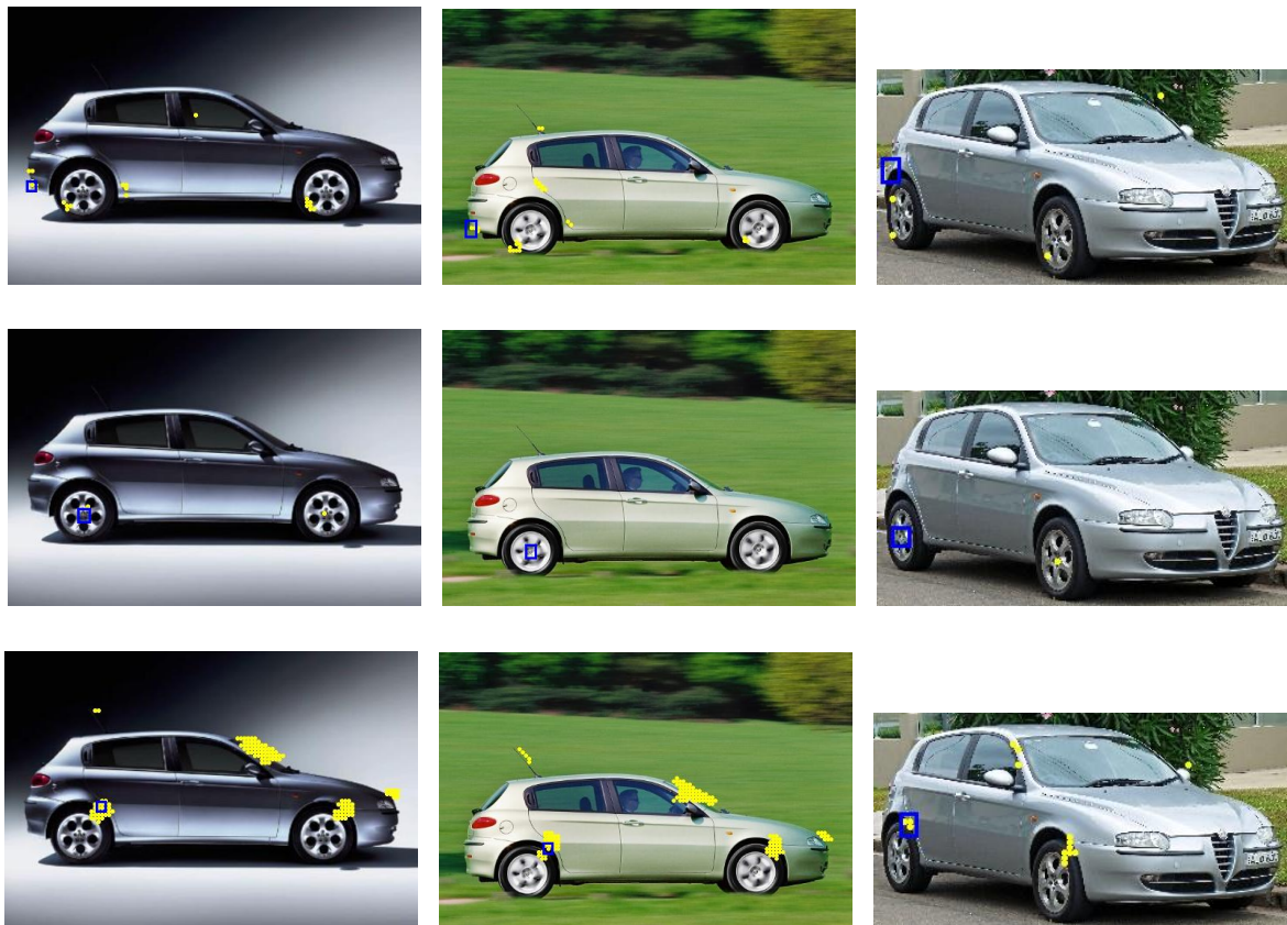
FIGURE IV.28 – Exemple de résultats pour les détecteurs de parties de voiture. Chaque ligne correspond à un détecteur différent. La bonne position pour la partie est encadrée en bleu. Les ronds jaunes représentent les primitives renvoyées par le détecteur concerné.
