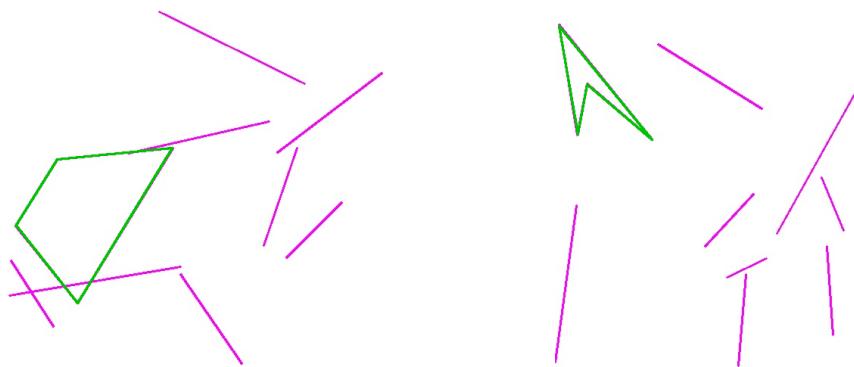
FIGURE IV.3 – Deux exemples de scénarios pour des polygones à 4 sommets. En vert le polygone à trouver, en rose d'autres lignes présentes (bruit).
