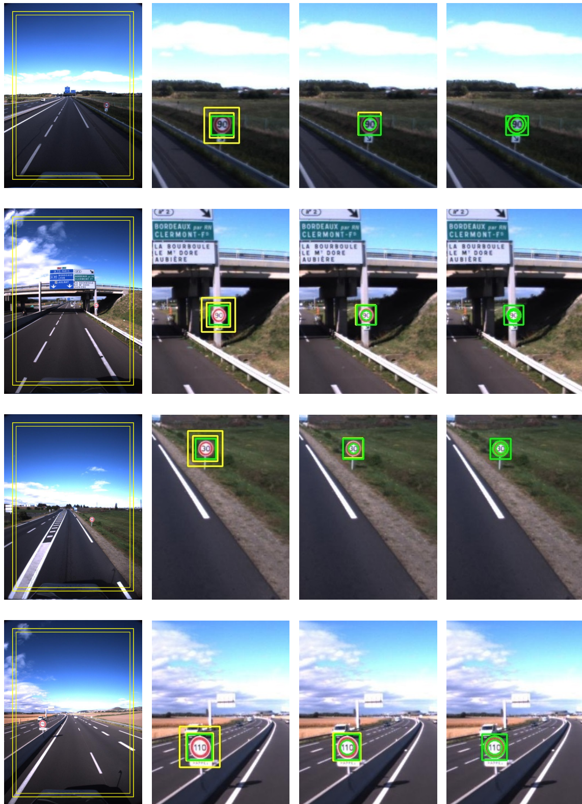
FIGURE IV.21 – Exemple de zones de focalisation. La première colonne correspond au début de l’algorithme. Les zones de focalisation sont dessinées en jaune. La zone la plus petite est celle pour la partie petitCercle , la zone légèrement plus grande correspond à la partie grandCercle , enfin la zone de focalisation pour le blobRouge est toute l’image. La première colonne est la seule pour laquelle l’image complète est représentée. Pour les trois autres colonnes, seule une région autour du panneau est affichée afin de permettre une meilleure visualisation. Sur la deuxième colonne, en vert, la zoneRouge correspondant au blobRouge après détection est montrée. Les zones de détection pour les deux autres parties se sont réduites. La troisième colonne montre le résultat après la détection des deux premières parties (les primitives associées sont toujours dessinées en vert) et en jaune, la zone de focalisation pour la partie restante. Enfin, la dernière colonne montre le résultat final lorsque toutes les parties ont été trouvées.
