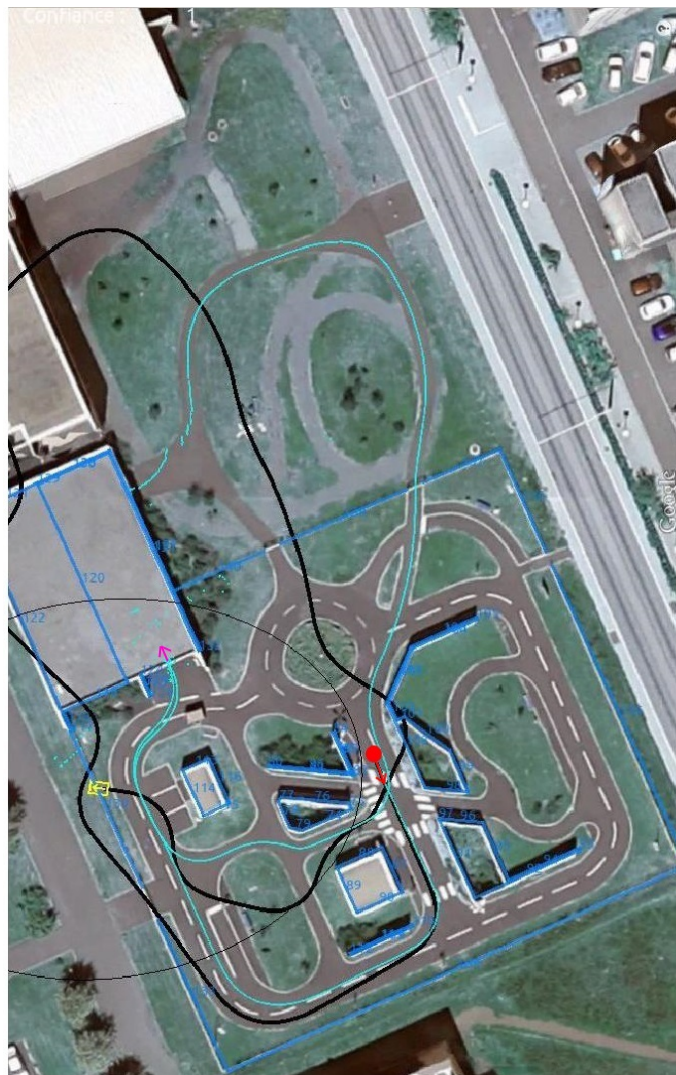
FIGURE IV.31 – Résultats pour la localisation à l'estime. La trajectoire estimée est représentée en noir. Le point de départ est représenté en rouge, le point d'arrivée estimé par le rectangle jaune, le point d'arrivée réel par la flèche magenta. La trajectoire de référence (donnée par le GPS-RTK) apparaît en cyan. Les différents éléments référencés de la carte sont représentés en bleu.
