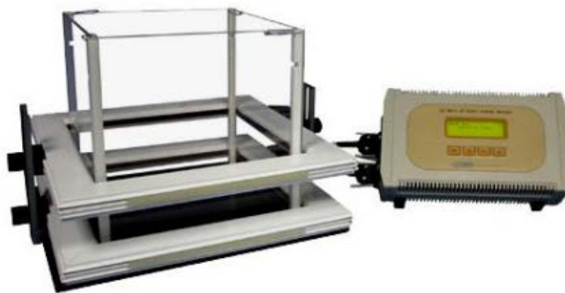
Figure 12: Open Field infrarouge, utilisé pour la mesure de l'activité locomotrice spontanée des rats au moyen des rayons photo-électriques infrarouges (BIOSEB, USA)
