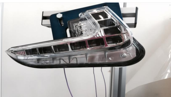
Figure IV.7 Supports du feu à Leds en laboratoire
