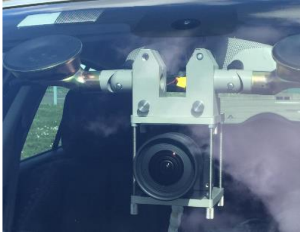
Figure IV.3 Caméra rapide embarquée sur véhicule « suiveur »
