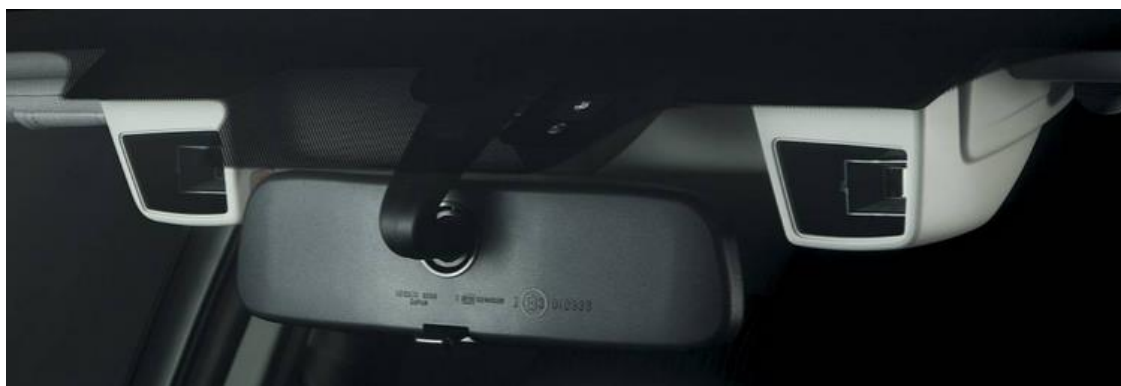
Figure I.12 Caméra Stéréo EyeSight (Subaru)
