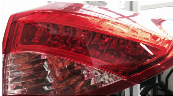
Figure IV.9 Feu de position arrière rouge à Leds
