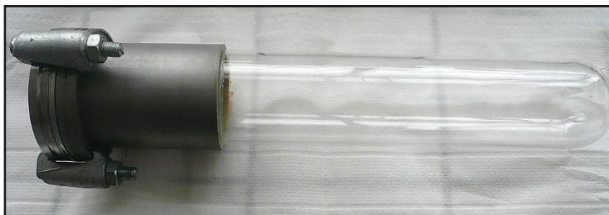
Figure II - 21 : Montage en silice utilisé pour les réactions à l'état solide et dans lequel est introduit le creuset en carbone vitreux
