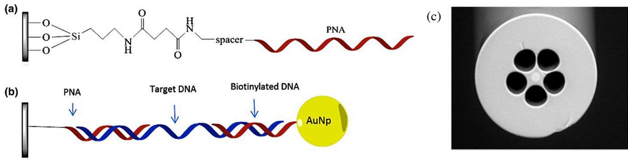
**Fig. 14.** a) Représentation de l'introduction de la séquence d'ANP à l'intérieur à la surface des canaux; b) vue schématique du système sandwich utilisé pour la détection d'ADN; c) image SEM du PCF 5-trou utilisé pour ce travail.
