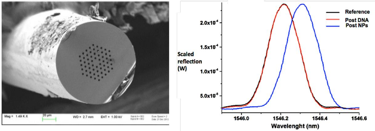
**Fig. 16** Gauche) Image SEM de la fibre optique LMA-10 utilisé dans cette étude, montrant la géométrie hexagonale de ses 60 micro-canaux; Droite) Décalage de la longueur d'onde dans le mode réflexion (i) avant (noir), (ii) après ADN (rouge), et (iii) après introduction des nanoparticules d'or (bleu), en utilisant un échantillon contenant 10% d'ADN génomique, donnant un décalage moyen de 0,08 nm (RSD 27%).
