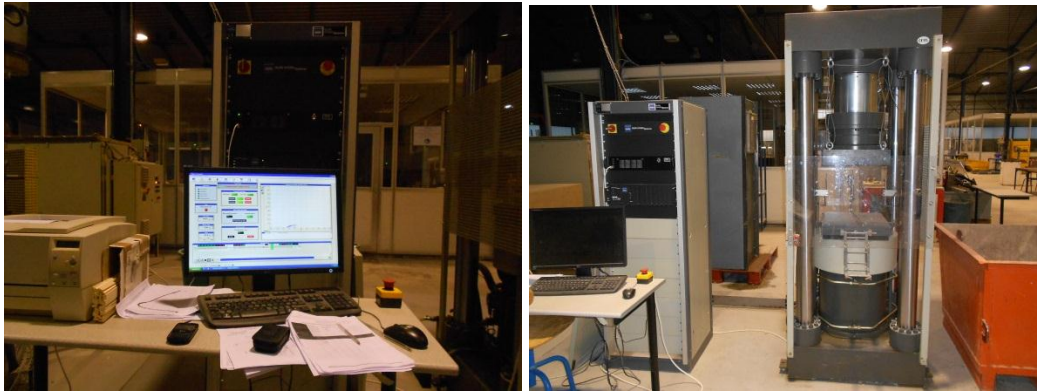
Figure 84 : Presse hydraulique pour les essais mécaniques sur bétons
