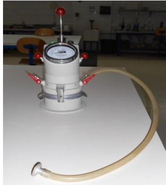
Figure 81 : Mesure de la teneur en air avec un aéromètre à mortier
