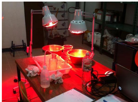
Figure 25 Dispositif de séchage utilisé pour les sables
