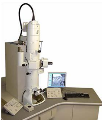
Figure 5-1. Photographie du dispositif expérimental de microscopie électronique en transmission au sein de la plateforme Imagif : microscope électronique en transmission de 120 kV JEOL 1400
