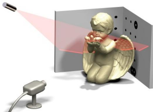
FIGURE 4.3: Exemple de système à base de triangulation laser<sup>1</sup>
