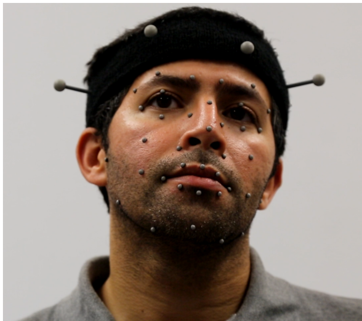
FIGURE 5.5: Disposition des marqueurs lors de la session de capture de mouvements
