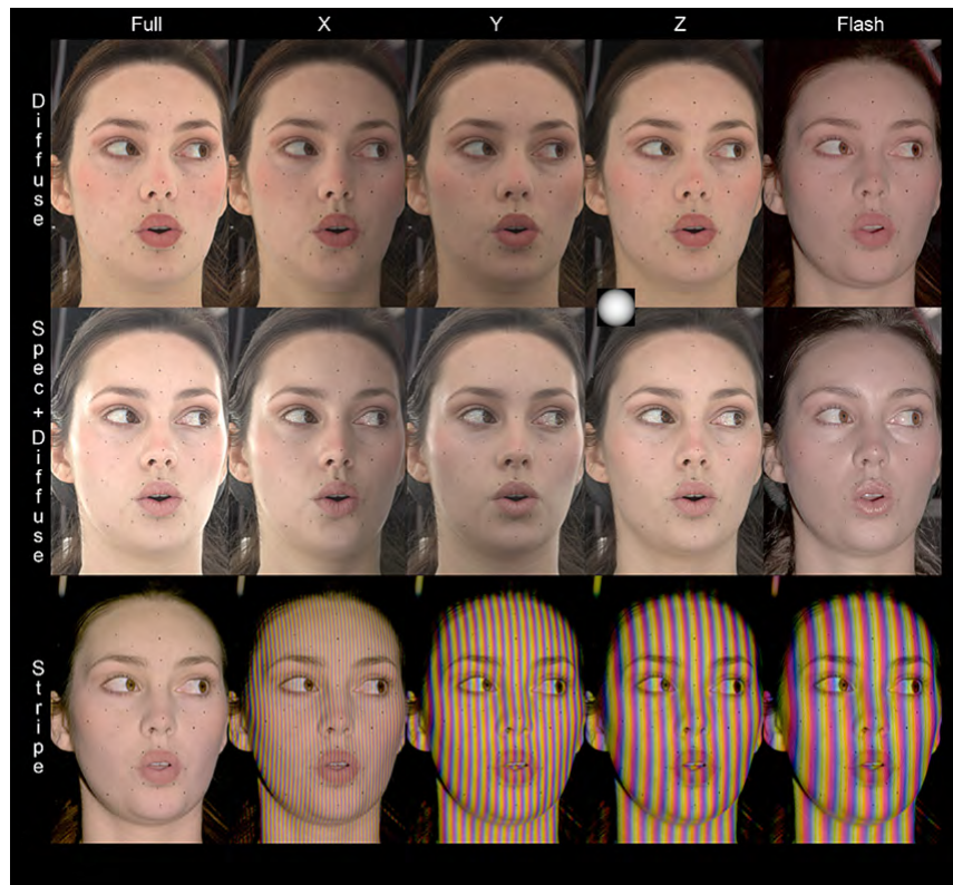
FIGURE 4.6: Exemple de système à base de lumière structurée (Von der Pahlen et al., 2014)
