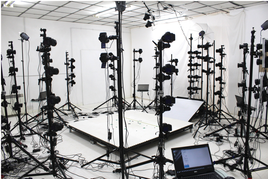
FIGURE 4.7: Une set-up de photogrammétrie de qualité professionnelle (infinite Realities 3 )
