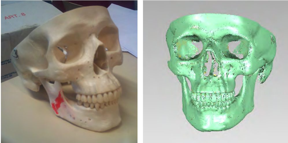
Figure 126 : à gauche, squelette en plastique du commerce. A droite, acquisition surfacique du modèle
