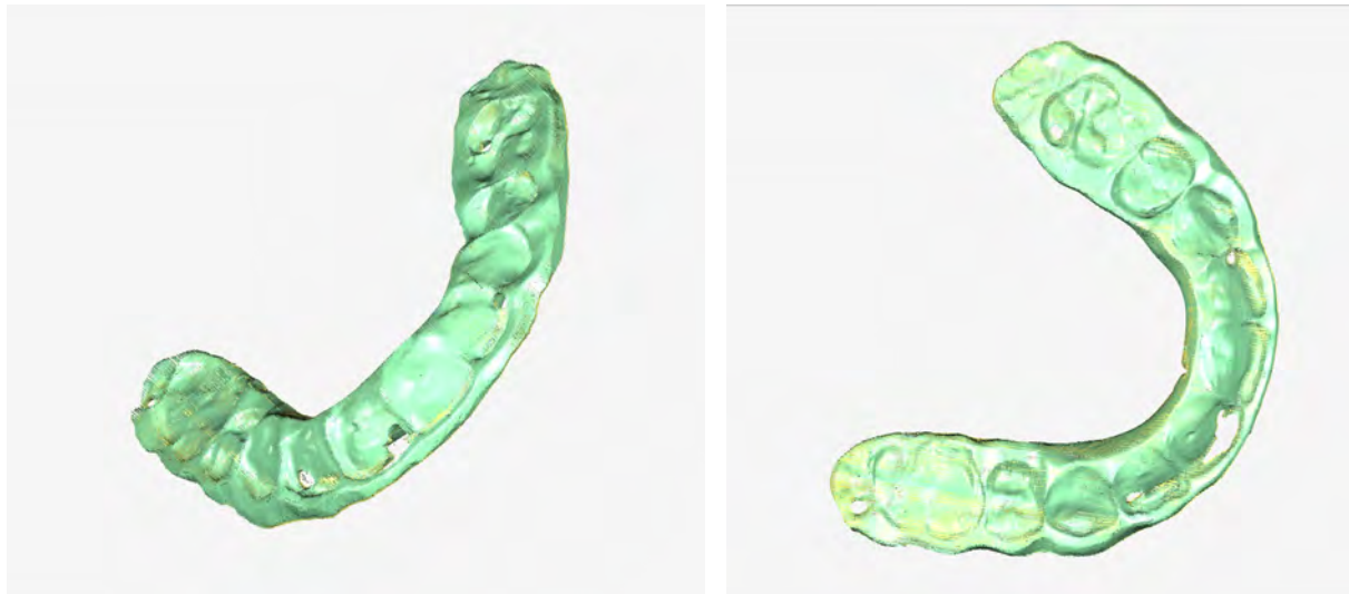
Figure 78 : nuage de point de la gouttière scannée (scanner laser de surface).
