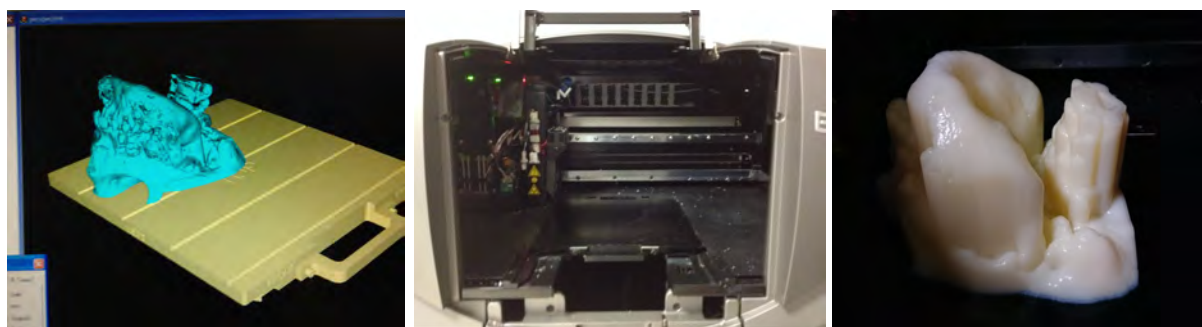
Figure 136 : à gauche, l'objet est placé sur le plateau d'impression virtuellement par le logiciel. Au centre, imprimante ouverte. A droite, objet imprimé sur le plateau.
