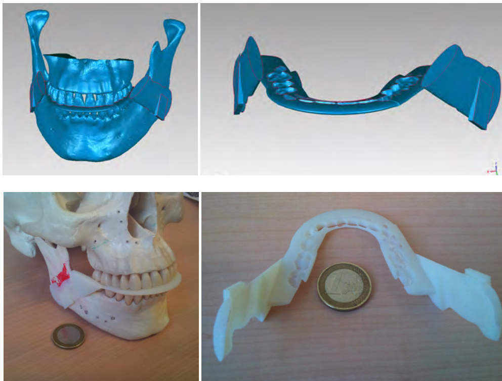
Figure 127 : en haut, modélisation de l'OCPD monobloc clippé. En bas, guide imprimé et mis en place sur le squelette à gauche.
