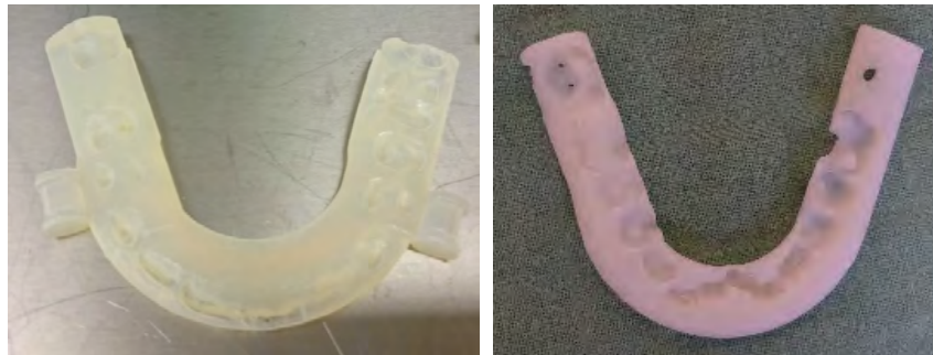
Figure 138 : à gauche matériau biocompatible. A droite, matériau rigide opaque.
