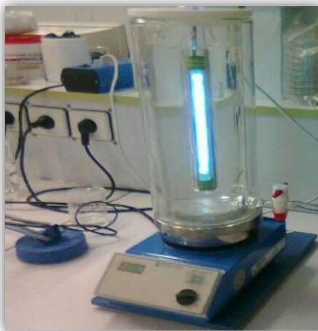
Fig.II-1 : Schéma du réacteur cylindrique : Diamètre interne ( d= 7\text{cm} ), Volume ( V = 2\text{ L} ).
