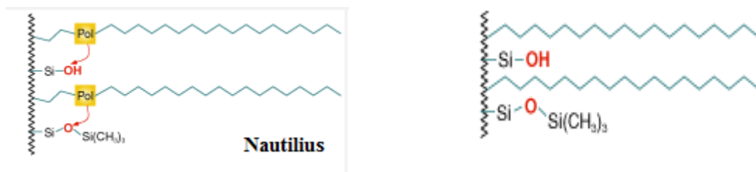
Fig. II-7: Comparaison entre la colonne Nucléosil C18 du type Nautilus et la colonne Nucléosil C18 ordinaire. ( WWW.mn.net.com/HPLC Star, Macherey-NAGEL, consulté le 3 mars 2015).
