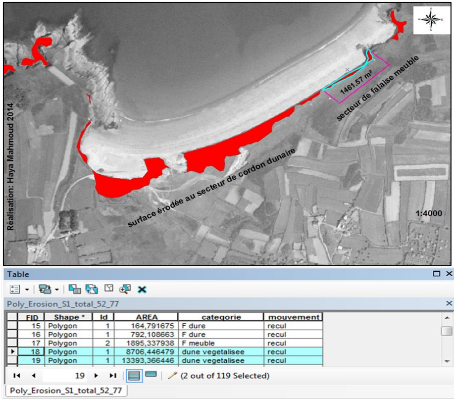
Figure 69 : photo et table d'attributs de la surface érodée entre 1952-1977 Anse du Verger (L'unité d'Area : m 2 )
