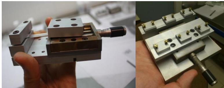
Figure 25 : Systèmes permettant d'étirer un échantillon (g) ou trois échantillons à la fois (d)
