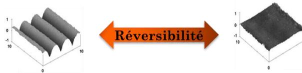
Figure 20 : Réversibilité de la structuration linéaire par images AFM avant et après étirement
