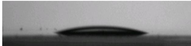
Figure 7 : Angle de contact du PDMS après traitement plasma de 5min (18W)
