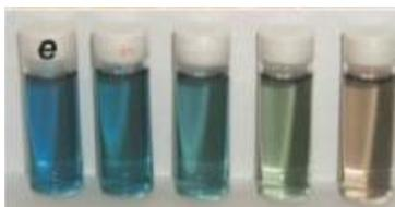
Figure 10 : Photographie optique de dispersions colloïdales de nano-bâtonnets d'or de différents rapports d'aspect (de gauche à droite : du plus petit au plus grand rapport d'aspect)
