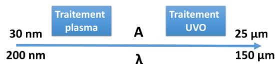
Figure 40 : Gamme des longueurs d'onde et amplitudes obtenues
