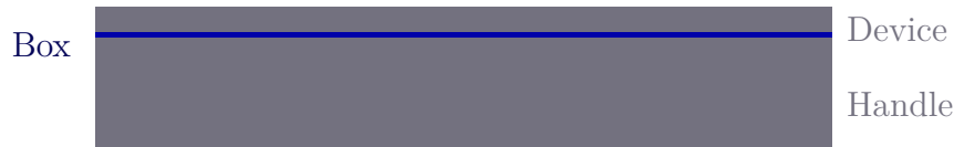
FIGURE 3.2 – Schéma de la structure d'un substrat SOI.
