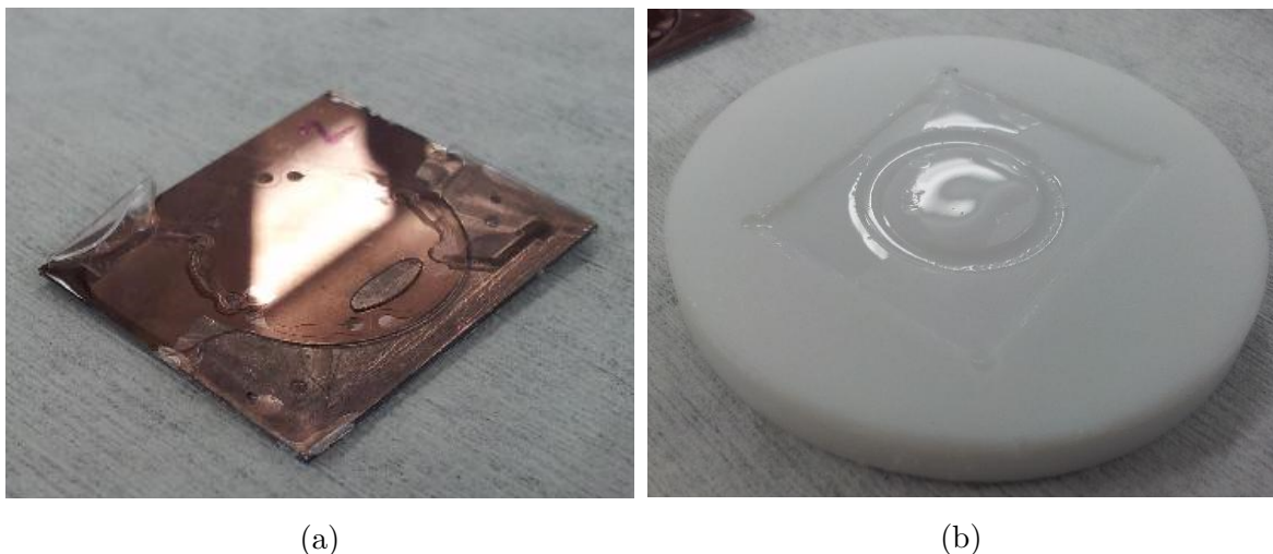
FIGURE 26 – Essai de transfert du film PDMS sur la surface d'un micro-HP, (a) micro-HP et (b) film + moule en téflon.
