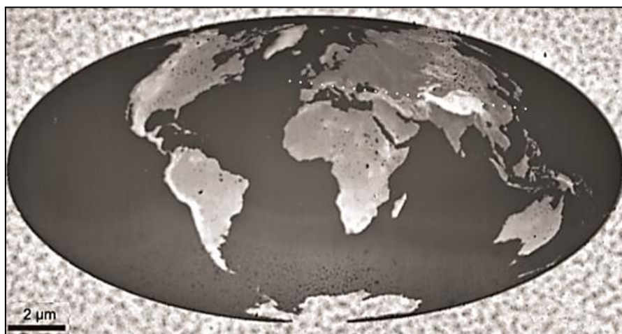
Figure I-15 : Image AFM d'une structure 3D représentant le globe terrestre formée par réaction thermique d'un polymère en polyphthalaldéhyde 79
