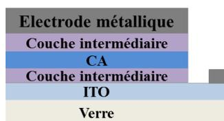
Fig. 1.14: Schéma générale d'une cellule photovoltaïque organique
