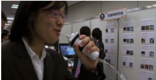
FIGURE C.11 – TagCandy émet des impulsions électriques et propage des sons en fonction de la manière de manger une sucette. [Narumi et al., 2010]
