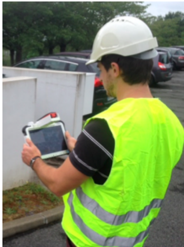
FIGURE 9.2.3 – Couplage laser-tablette sur le chantier
