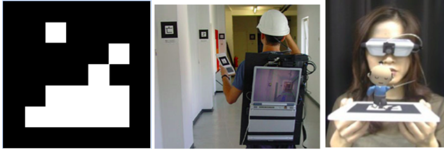
FIGURE 7.3.13 – (à gauche) Le premier marqueur par [Rekimoto, 1998] est une matrice carrée, (au milieu) les marqueurs ARToolkit donnent des indications de position à un dispositif de RA (à droite) ARToolkit [Kato and Billinghurst, 1999] , disponible en licence GPL, permet aux dispositifs de RA compatibles de se situer et de situer leurs augmentations sur le réel
