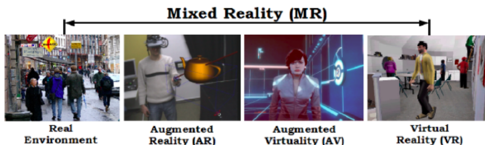
FIGURE 7.1.1 – Illustration du continuum [Milgram et al., 1995] de la RA par [Sareika and Schmalstieg, 2008]
