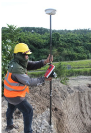
FIGURE 3.1.2 – Lever topographique d'un point avec un GNSS RTK
