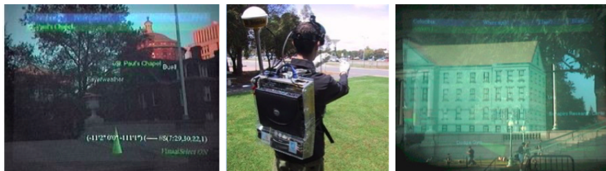
FIGURE 7.3.12 – Touring Machine [Feiner et al., 1997] (à gauche), Map-in-the-Hat [Thomas et al., 1998](au milieu) et MARS [Höllerer et al., 1999] (à droite) couplent GPS et boussole électronique pour se repérer dans l’espace physique
