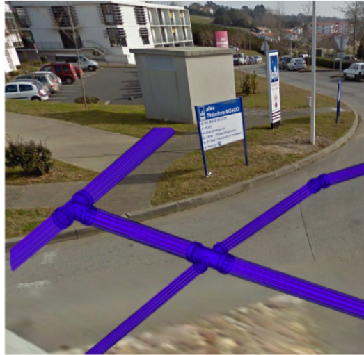
FIGURE 9.4.2 – Manque de corrélation entre modèle virtuel et scène réelle : où est précisément la canalisation ?
