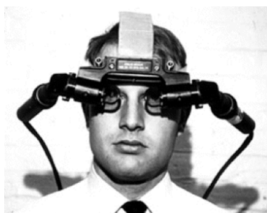
FIGURE 7.3.1 – Le premier dispositif de RA est un masque « see-through » [Sutherland, 1968].
