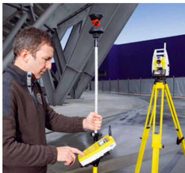
FIGURE A.6 – Visée sur prisme avec une station totale robotisée
