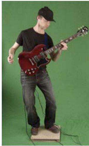
FIGURE C.8 – La guitare augmentée : divers capteurs sur la guitare, au sol et sur le guitariste transmettent des informations qui modifieront le rendu sonore [Lähdeoja, 2007]
