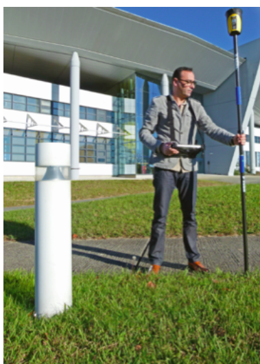
FIGURE A.3 – Géoréférencement d'une allée goudronnée au GNSS
